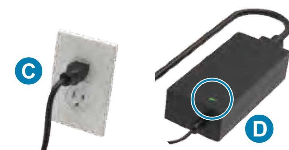
C. Conecte o cabo de alimentação a uma tomada apropriada.
