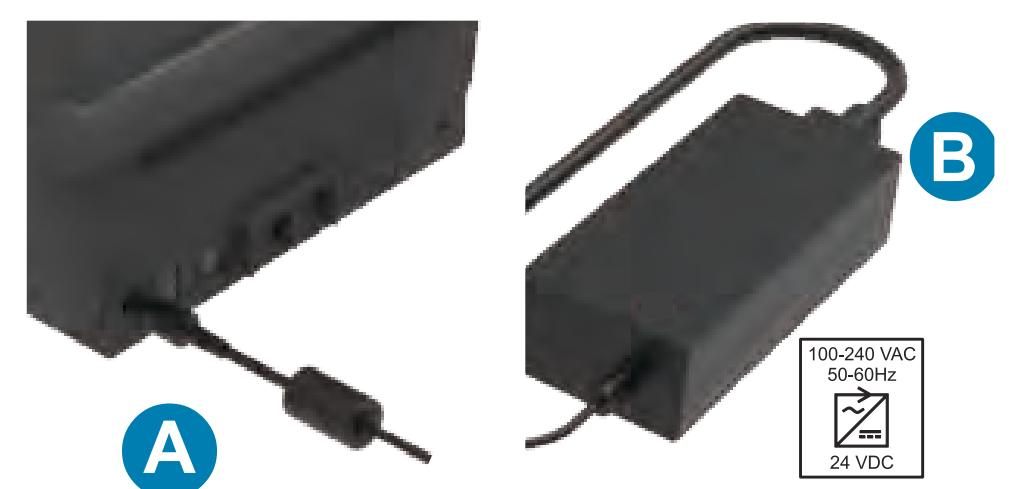
A. Conecte a fonte de alimentação à impressora.
